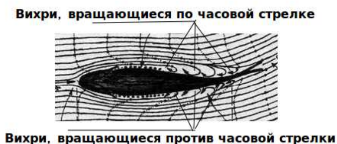
Рис.1. Механизм толкания рыбы водным потоком и вихрями.
