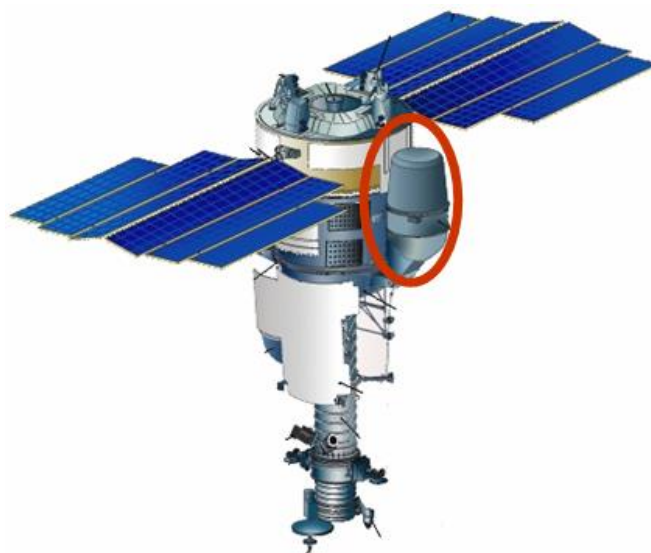
Рис. 1. Детектор «ПАМЕЛА» в контейнере на спутнике Ресурс-ДК
