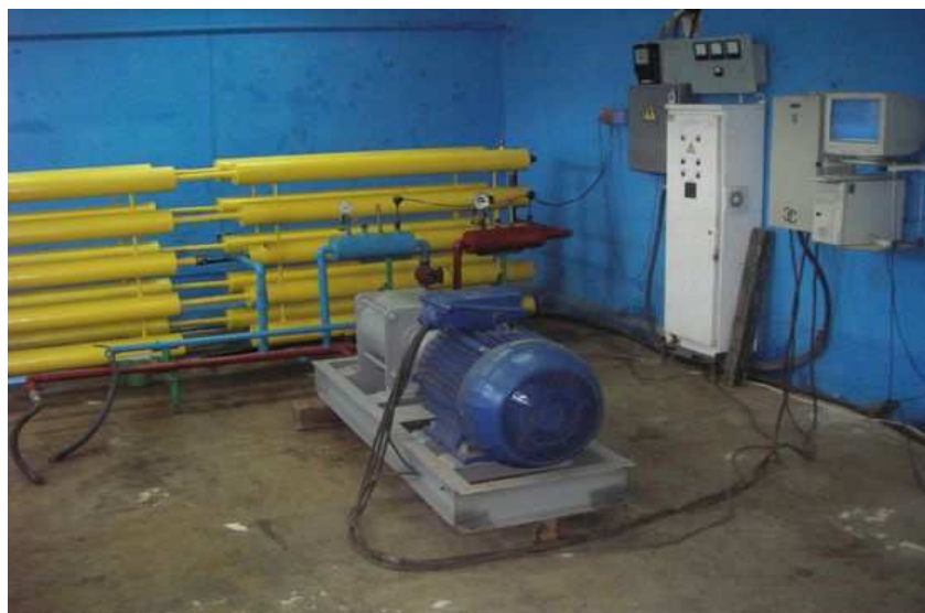
Фото. Испытательный стенд для определения работоспособности тепловых гидродинамических насосов ТС-1 (Фото из [40]).
