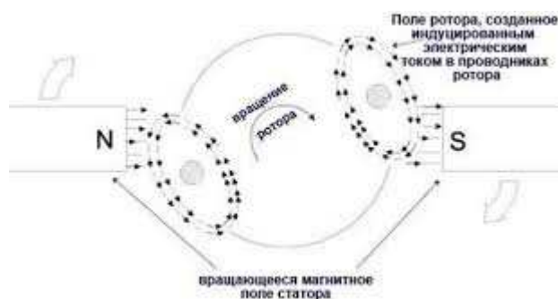
Схема взаимодействия магнитных полей статора и ротора в АД.
