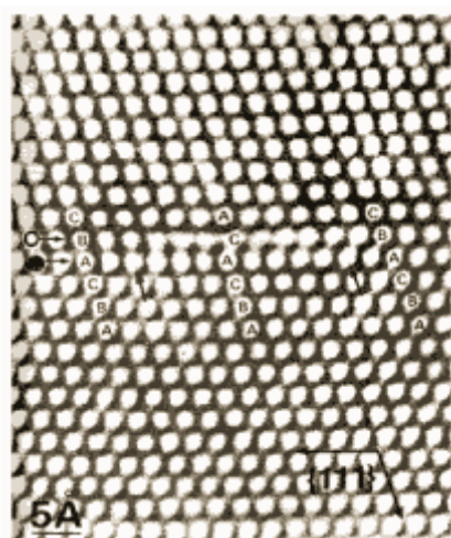
Рис.4. Электронная фотография кристаллической структуры золота. Масштаб (линейка внизу слева) – 5 ангстрем.
