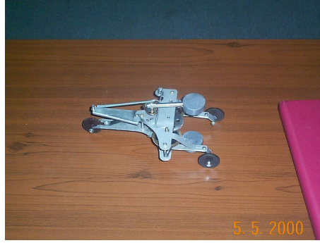
Рис. 1: Инерциоид Толчина, движущийся поступательно
