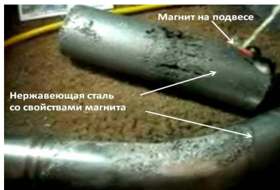
Рис. 8. Нержавеющая сталь обретает магнитные свойства
