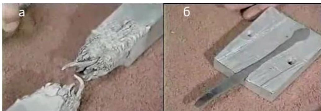
Рис.6. Разрушенный кусок алюминия а) и стальной нож, «вплавленный» в алюминий б)
