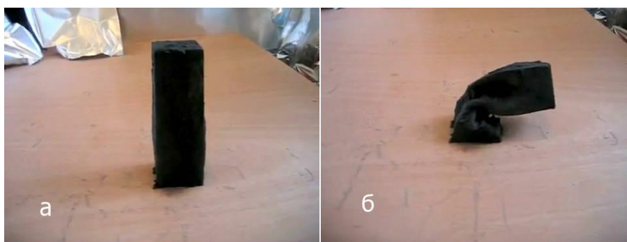
Рис.5. Образец железа а) до включения генератора; б) через 30 сек после включения
