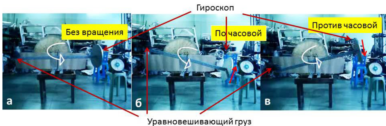
Рис.2. Прецессирующий гироскоп на рычажных весах
