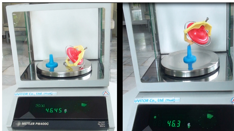
Рис.1. Слева измерен вес гироскопа с подставкой; справа вес того же гироскопа во время прецессии
