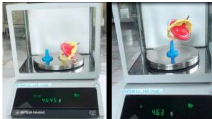
Рис.8. Слева измерен вес подставки и гироскопа без прецессии; справа вес того же гироскопа на подставке во время его прецессии
