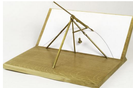
Рисунок прибора для вычерчивания параболы, его схематическое изображение и рабочая модель
